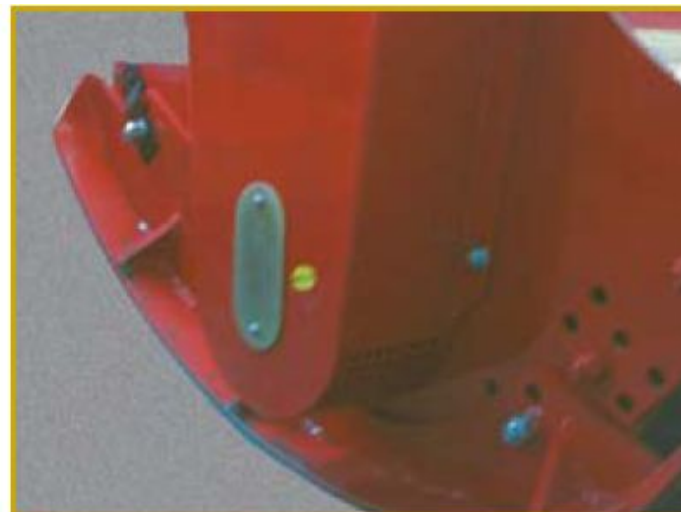
Aparatoare curele de antrenare cu ventilatie de racire, sine optionale
