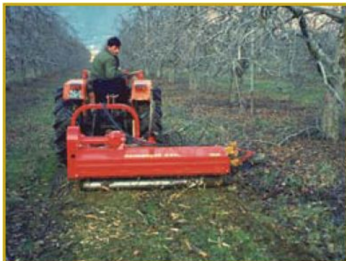
Mulcirea crengilor dupa tunderea pomilor si matura hidraulica
